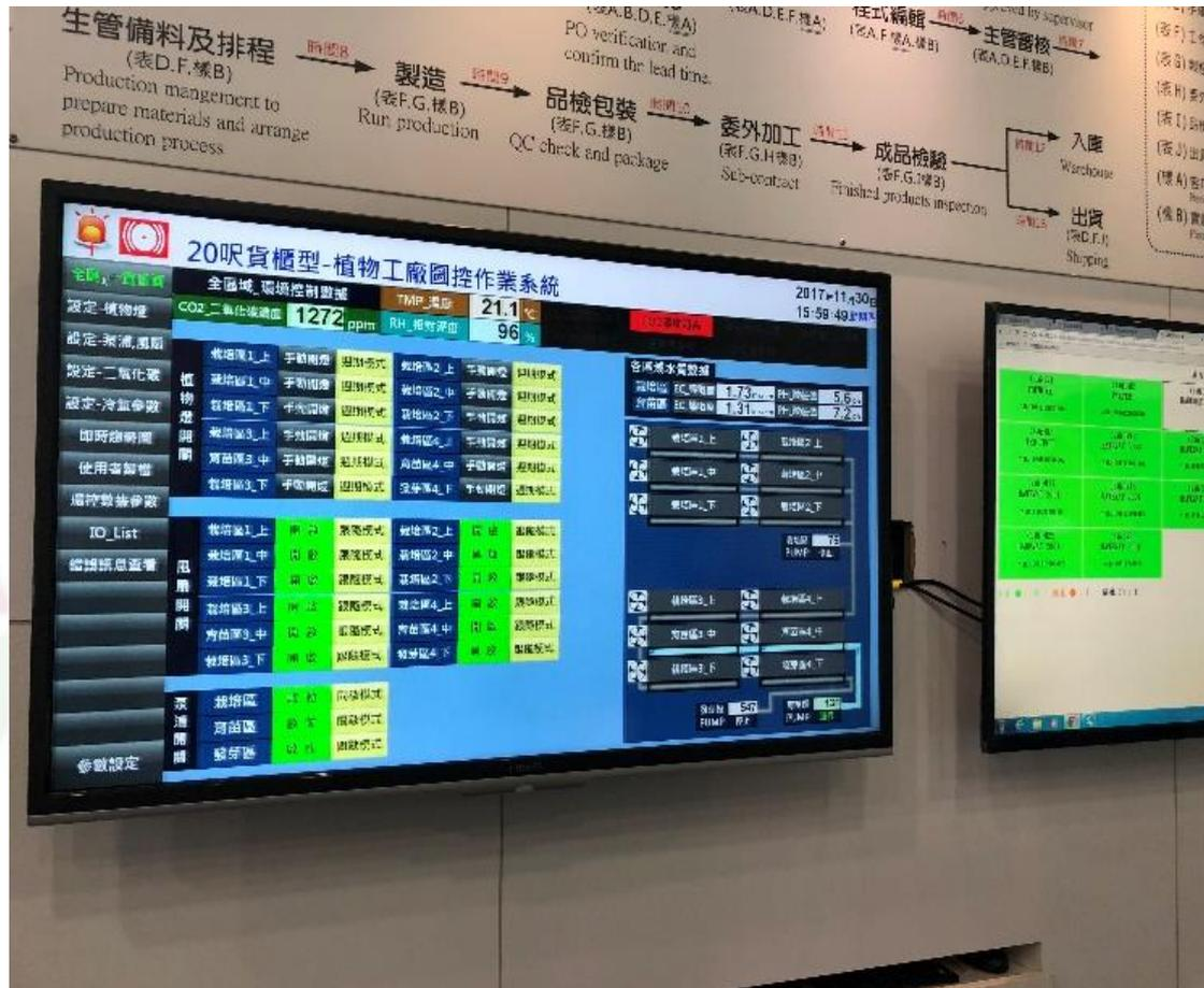
貨櫃型植物工廠中央圖控系統(照片為樂佳光能提供)
